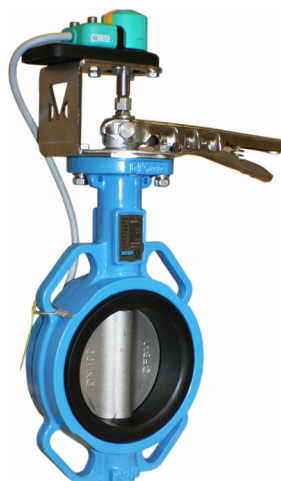
DN100 butterflyventil med induktiv tilbagemelder.
